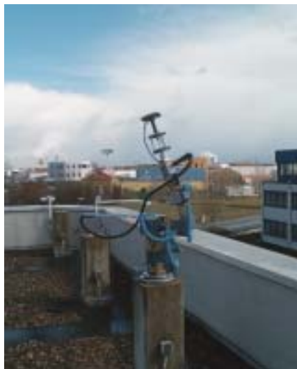
Fig 4. Kalibratie-robot met NETPOS-antenne en het bovenste deel van de mast.
