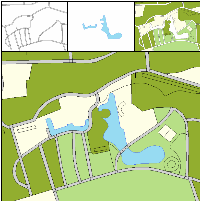
Figuur 3.7: vlakvormige weggedelen, waterdelen en terrein zijn aanééngrenzend en landsdekkend.
